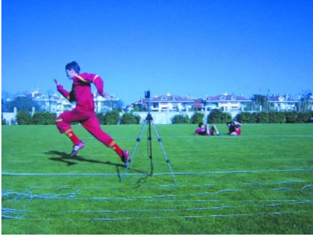
Resim-6: Saha ortamında uygulanan sür'at testi. Fotosellerin yerleştiriliş şekline göre başlangıç noktasından istenen mesafelerde elde edilen sonuçlar bilgisayar ortamında izlenebilir. Aynı sistem kullanılarak şut sırasında topun hızı, reaksiyon zamanı, dikey sıçrama testleri de yapılabilir.
